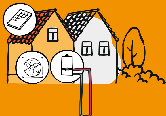
Warmtepomp bodem/lucht en zonnepanelen
